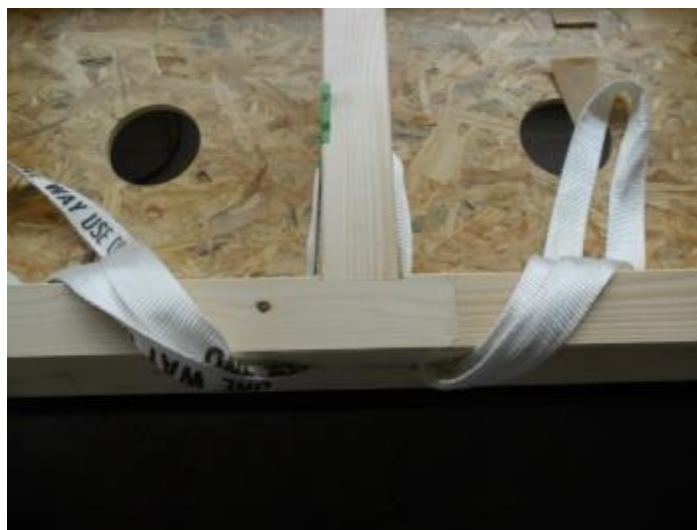
Figure 3 : Sangle de levage préinstallée dans le mur SYBOIS MUR avant fermeture de l'élément et insufflation de la ouate de cellulose
